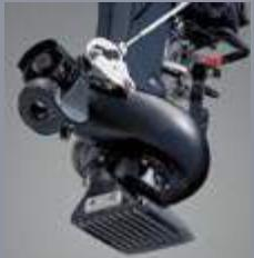
Этот мотор предназначен для небольших лодок, которым приходится преодолевать сложности мелких мест, пороги, песчаные отмели и так далее... При его создании были использованы хорошо отработанные технологии. Водометный мотор сконструирован простым и надежным. Им легко управлять, и он требует минимум ухода. Насос водометной приставки сконструирован таким образом, чтобы избежать лишних потерь мощности. Его характеристики почти соответствуют винтовому приводу.
