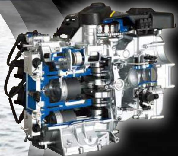
TLDI (Два такта, Низкое давление, Непосредственный впрыск)
